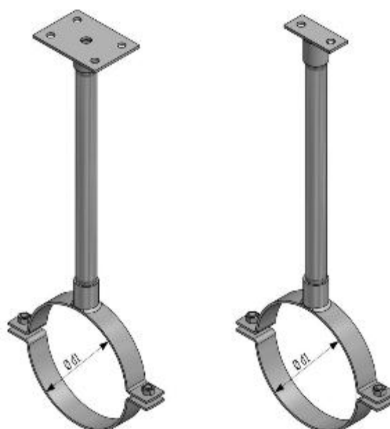
Rys.2 Podwiesie systemowe na rurę - montaż do ściany za pomocą kołków rozporowych, montaż do pomostu za pomocą podstawy i śruby gwintowanej z nakrętką
