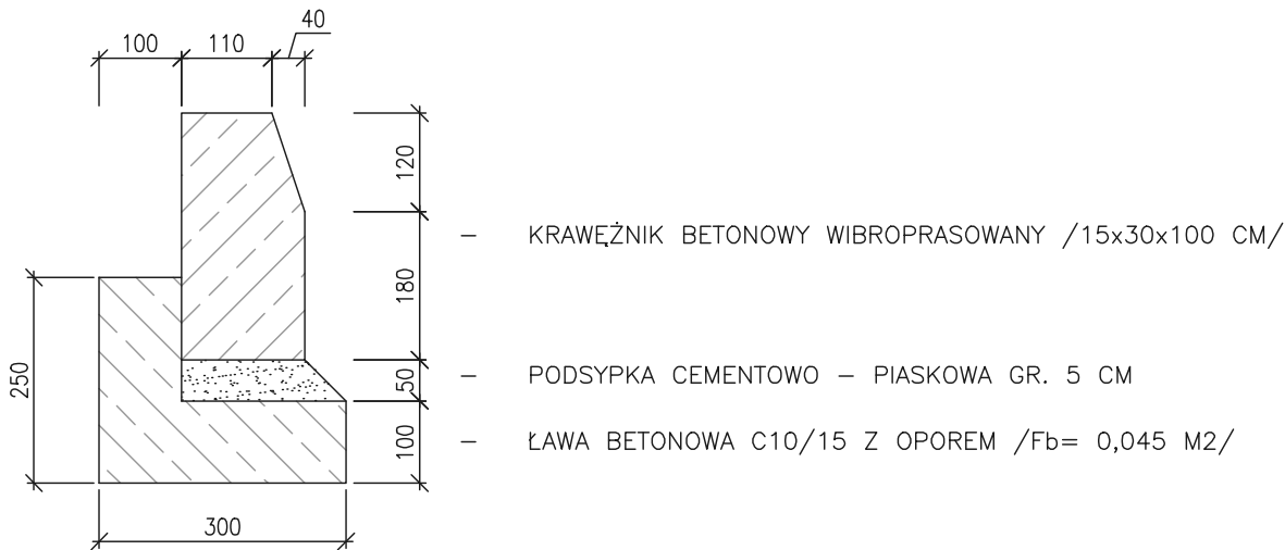
SZCZEGÓŁ KONSTRUKCYJNY SKALA 1:10 KRAWĘŻNIK UA-1/15/30/100 NA ŁAWIE BETONOWEJ Z OPOREM
