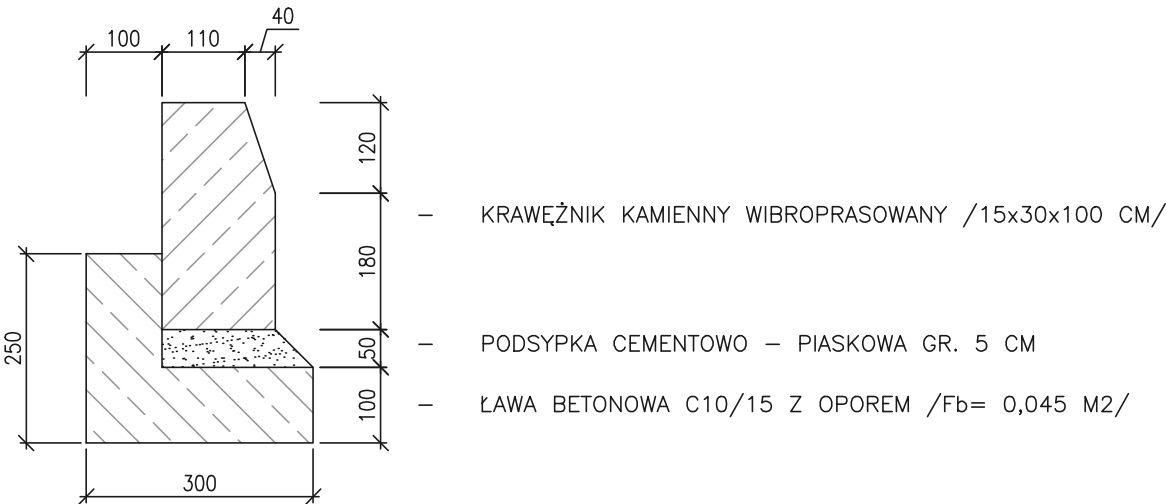
SZCZEGÓŁ KONSTRUKCYJNY SKALA 1:10 KRAWĘŻNIK KAMIENNY 15/30/100 NA ŁAWIE BETONOWEJ Z OPOREM
