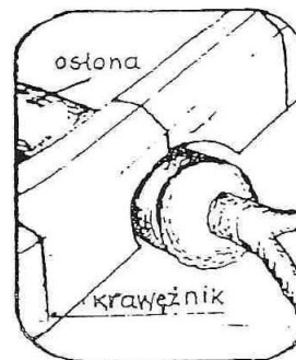
Rysunek: Zabezpieczenie korzeni przy układaniu krawężnika
