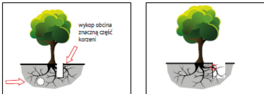
Rys. Rozwiązania niepoprawne – uszkodzenia systemów korzeniowych
